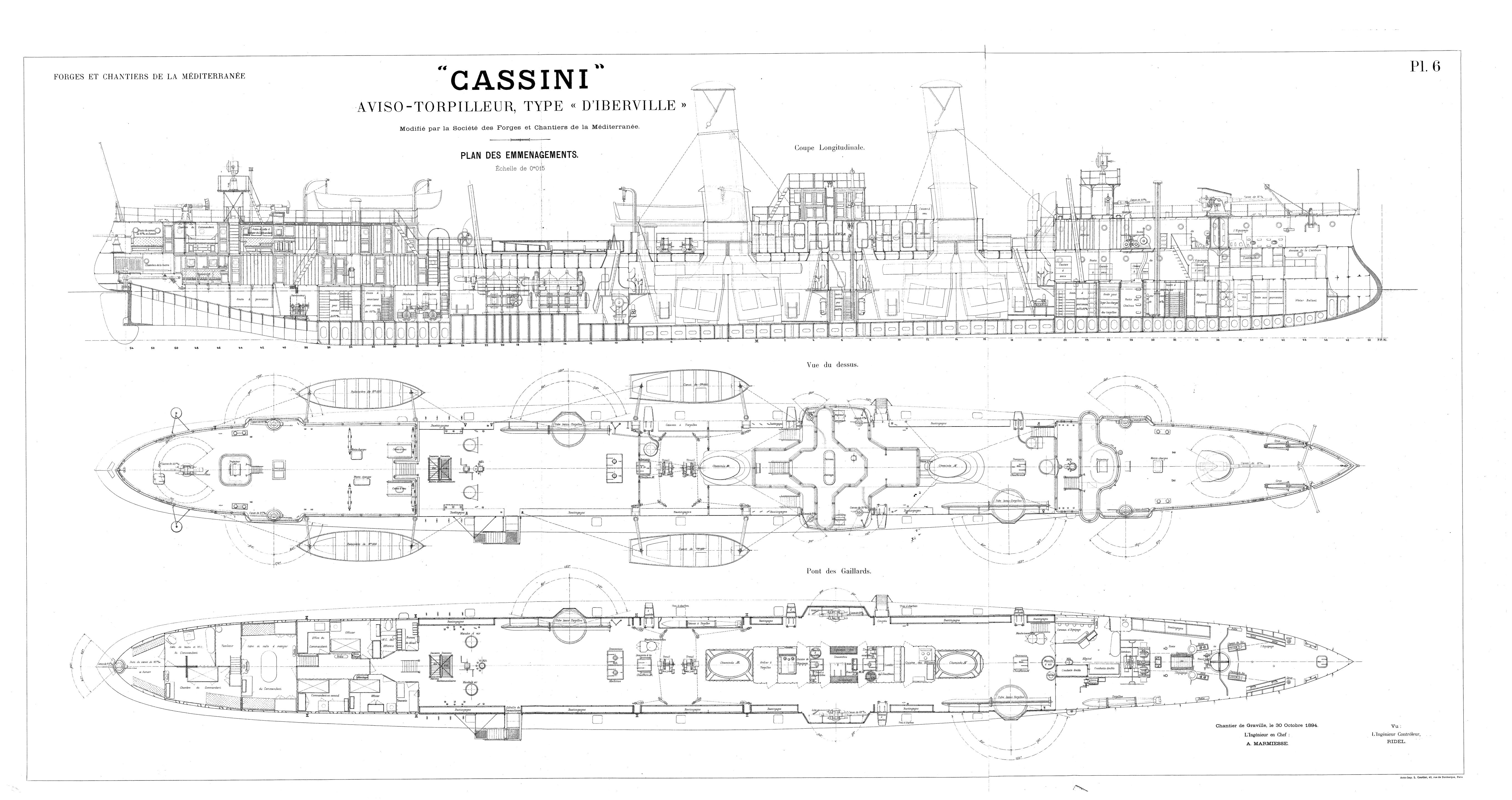
FORGES ET CHANTIERS DE LA MÉDITERRANÉE "CASSINI" AVISO-TORPILLEUR, TYPE « D'IBERVILLE » PLAN DES EMMÉNAGEMENTS. Échelle de 0<sup>m</sup>015. Coupe horizontale par l'axe des hublots. Coupe horizontale à la flottaison. Chantier de Graville, le 30 Octobre 1894. L'Ingénieur Contrôleur, L'Ingénieur en Chef : A. MARMIESSE.
