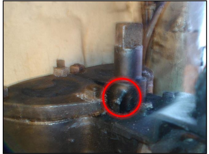
Filtres DG2 détail de l'index de l'axe de commande
